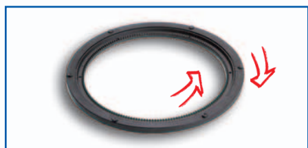
LE 320-10 za Ks Kuličkový otočný věnec z kovu o průměru 320 mm (vnější náklad), nosnost 300 kg, síla 13,4 mm bez nákladu, 16 mm s nákladem. Barva černá
