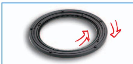
LE 280-10 za Ks Kuličkový otočný věnec z plastu, o průměru 280 mm (vnější náklad), nosnost 200 kg, síla 13 mm bez nákladu, 18 mm s nákladem. Barva černá
